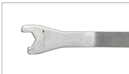
Стрелка у зева монтажного ключа SW13 указывает направление вращения при регулировке, когда ключ захватывает шестигранную головку.
